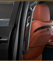
Inclusive Assist Handle มือจับยาวพิเศษกว่า 460 มม. ช่วยอำนวยความสะดวกให้ผู้สูงอายุและเด็ก ขึ้น-ลงรถได้ง่ายขึ้น
